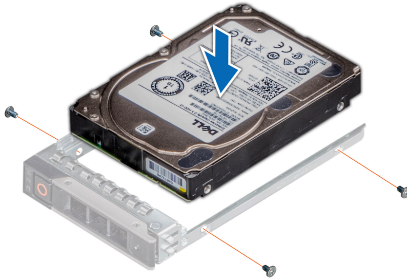
图 58: 将硬盘驱动器安装到硬盘驱动器托盘中
